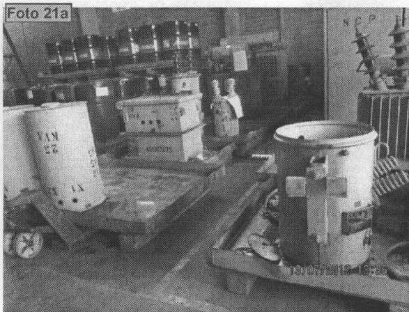
Fotografías N° 21a y 21b – Transformadores desmontados en proceso de mantenimiento en los talleres de la empresa TECSUR S.A., ubicado en Av. Pedro Miotta Cuadra, distrito de San Juan de Miraflores.
