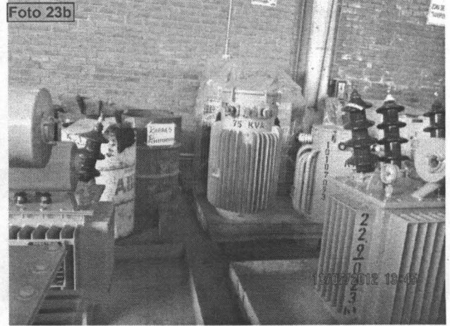
Fotografías N° 23a y 23b – Transformadores reparados en los talleres de la empresa TECSUR S.A., listos para ser entregados a LUZ DEL SUR S.A.A.
