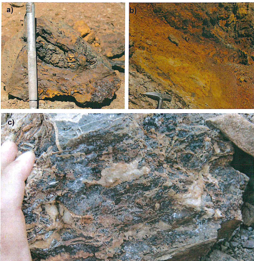
Figura 7-106. Presencia de pirita, sulfuros y óxidos en el sector de Katrina: a) Venillas y patinas de pirita, ferrihidrita, goetita; b) goetita y hematita; c) venillas de galena, esfalerita y calcopirita
