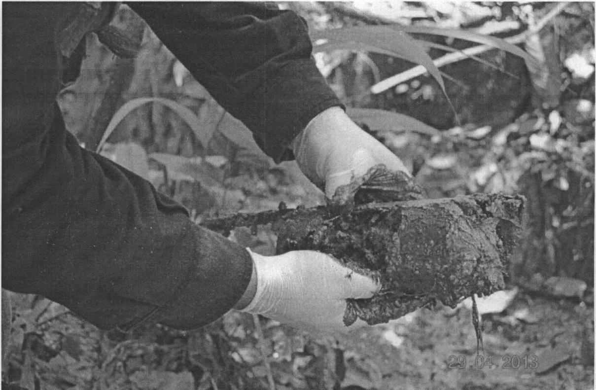
**Fotografía 19** Toma de muestra de suelo para el parámetro hidrocarburo en el punto S23 (vita de suelo impactado).
