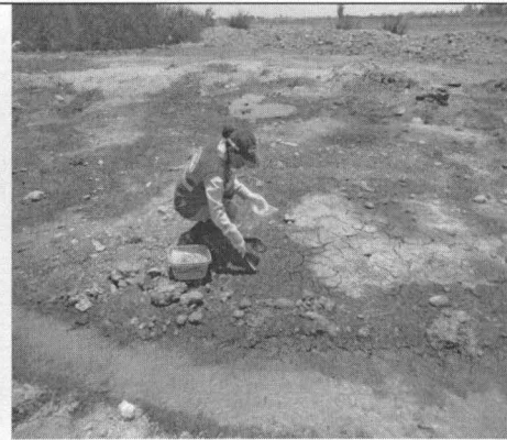
Fotografía 5. Toma de muestra en suelo con diferente característica, se aprecia la diferencia de tonalidades, así como el curso del vertimiento.
