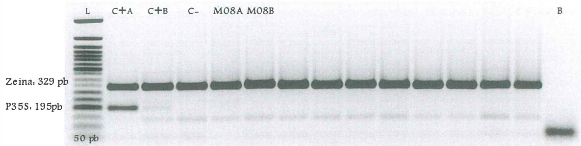
Figura 1. Perfil electroforético de los productos amplificados por PCR para detección del promotor 35S (195 pb) e identificación del gen zeina (329 pb). L: ladder 50 pb; C+A: control positivo al 1%; C+B: control positivo al 0.1%; C-: control negativo; B: blanco (mezcla para PCR sin ADN).
