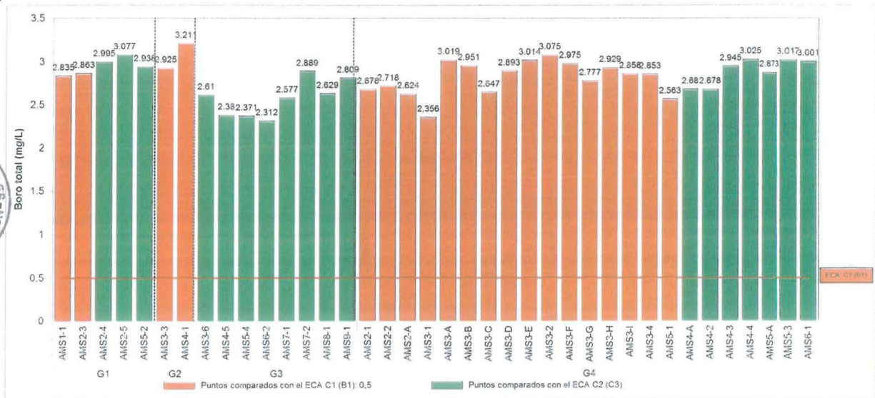
Figura 10-23. Concentración de boro total en agua de mar a nivel de superficie en el ambiente submareal
