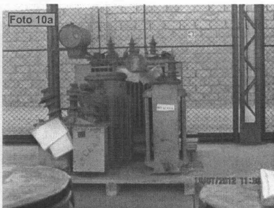
Fotografías N° 10a y 10b – Transformadores con PCBs dispuestos en el interior del almacén de la empresa Luz del Sur S.A.A. Ubicado en el distrito de Chilca, Km 63 de la Panamericana Sur.
