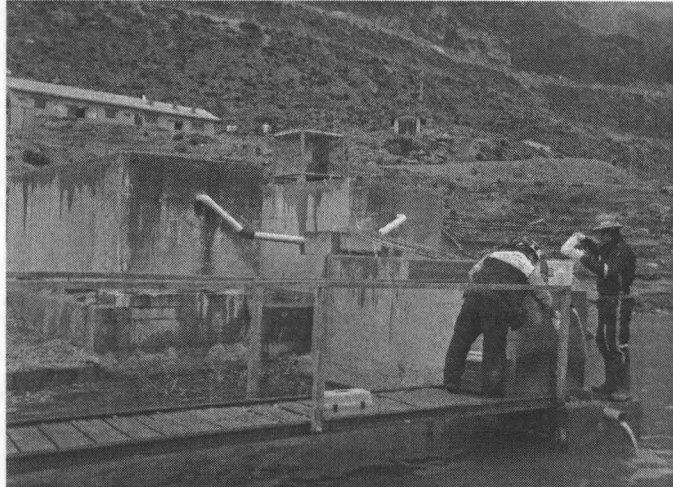
Foto: Toma de muestras de aguas residuales domésticas de la Unidad Minera Raura.
