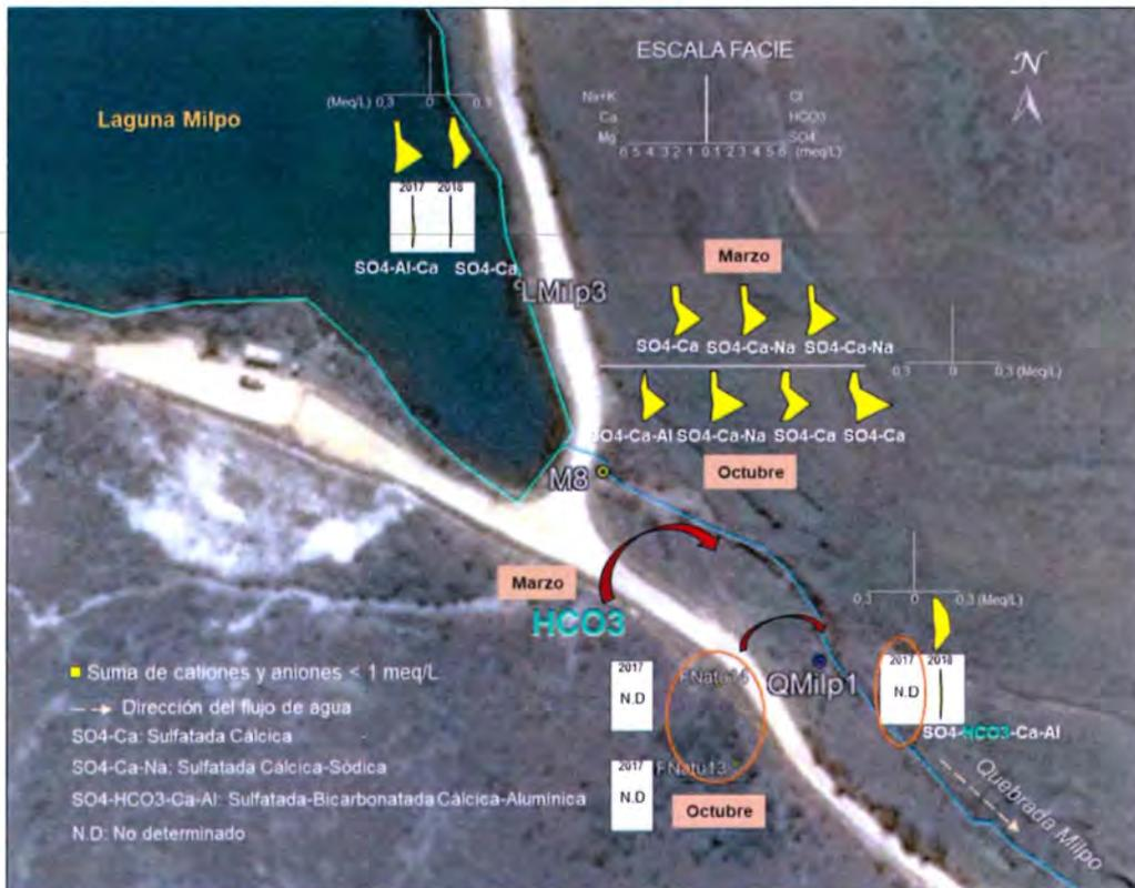
Figura 8-24. Cambio en la composición hidroquímica de QMilp1 con respecto al punto M8 de Lumina Copper S.A.C.
