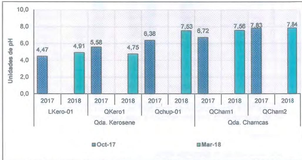
Figura 7-318. Valores de pH registrados en octubre de 2017 y marzo de 2018 en las quebradas de la Microcuenca de la Qda. Kerosene
