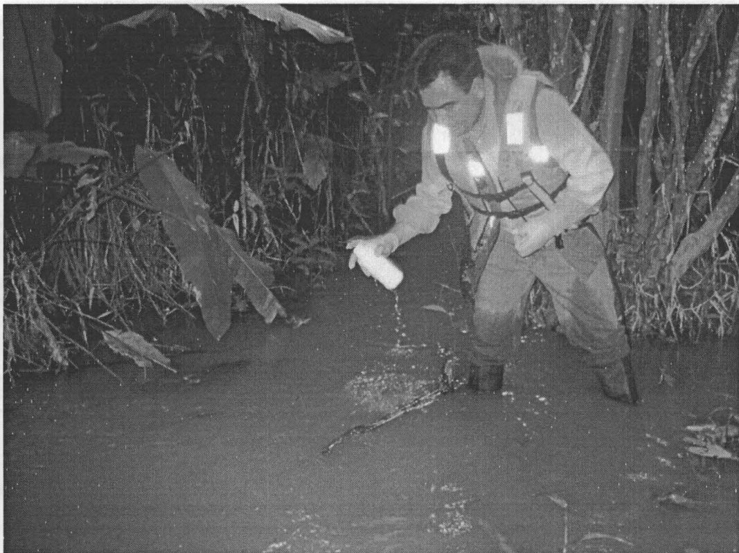
Fotografía 10 Muestreo de agua superficial (M02), para análisis de metales
