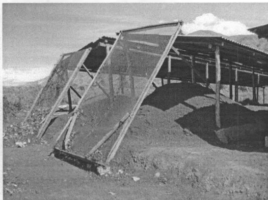
Foto 19: Proceso de cernido del material tratado
