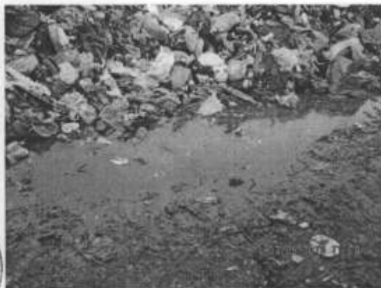
Foto 16: Lixiviados en la base de la pila de residuos, producto de la descomposición orgánica y del agua de lluvia
