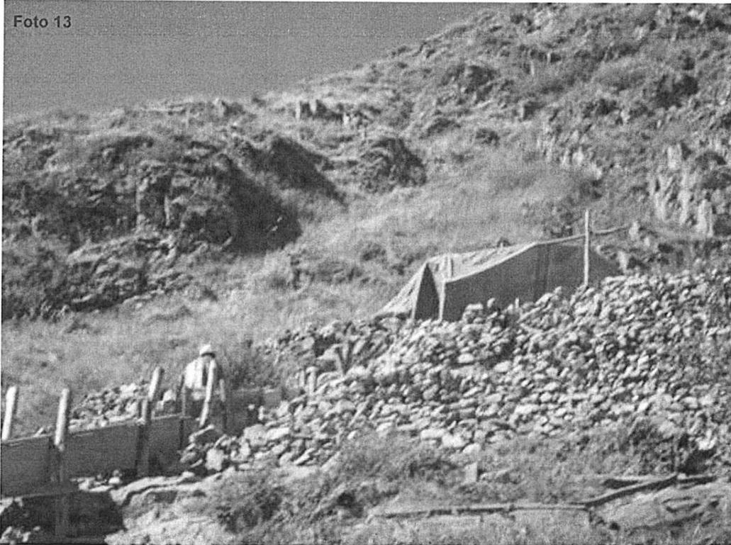
Fotografía N° 13. Evidencia de instalaciones artesanales de tolvas para el traslado de mineral, por la ladera del cerro de la mina Vale un Perú, en el punto georeferenciado N° 3, del Cuadro N° 1. Coordenadas UTM WGS 84 (17L 0828226E 9004909N)
