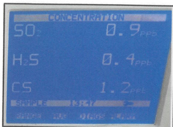
Fig. 05. Verificación con aire zero.
