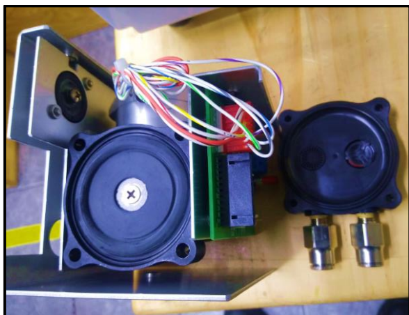
Fig. 3. Mantenimiento de la bomba de succión.
