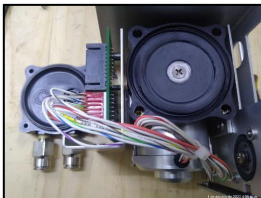
Fig. 3. Mantenimiento de la bomba de succión.
