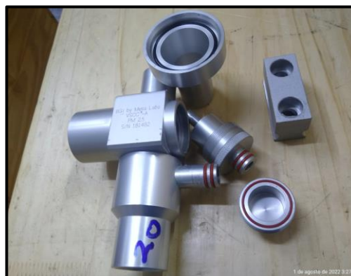
Fig. 4. Mantenimiento del impactador PM2.5.
