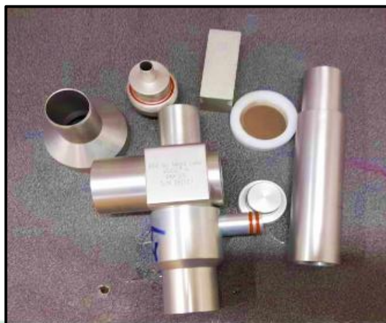
Fig. 4. Mantenimiento del impactador PM2.5.
