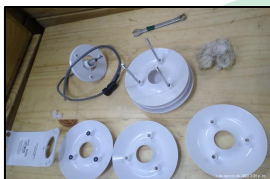
Fig. 5. Mantenimiento al sensor de temperatura externo.
