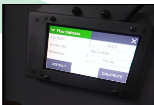
Fig. 6. Ajuste y verificación de flujo.
