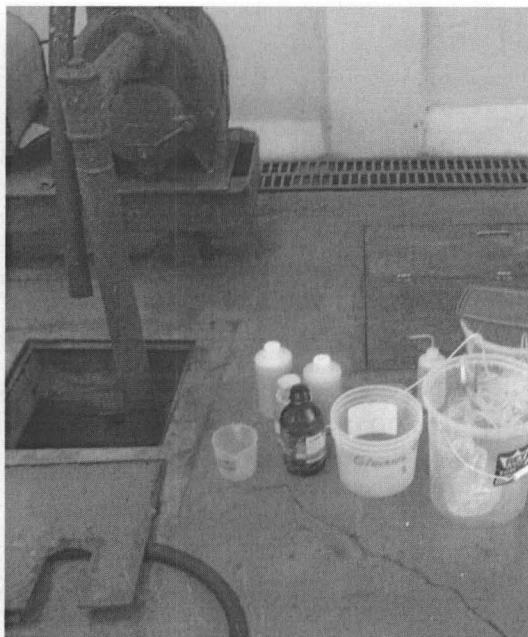
Fotografía 1. Punto de muestreo E-1. Caja que colecta aguas residuales del proceso industrial. Establecimiento industrial pesquero de la empresa de enlatados Cridani. S.A.C.
