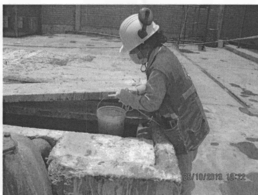
Fotografía 2. Punto de muestreo E-2. Efluente (tanque colector) antes del emisor. Establecimiento industrial pesquero de la empresa de enlatados Cridani. S.A.C.
