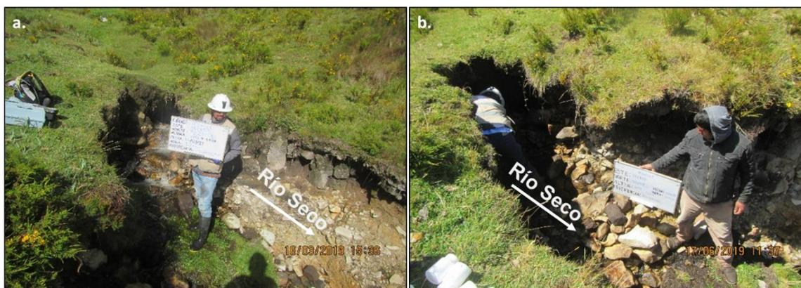
**Figura 9.6.** Socavación en el río Seco en el punto RSeco1. **a.** Temporada de avenida y **b.** Temporada de estiaje.
