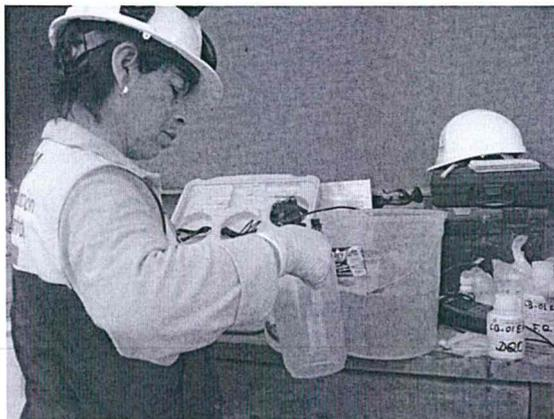
Fotografía 03. Toma de muestras para los parámetros establecidos en los LMP efluentes líquidos para subsector Hidrocarburos -Planta de tratamiento de aguas residuales domésticas - Campamento Base Betel- 23 de julio 2013.
