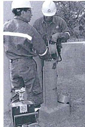
Pozo A. En acuífero Cascajal. Medición del nivel piezométrico. Marzo 2013
