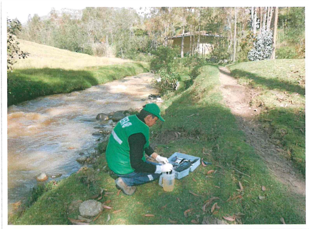
Fotografía N° 28: Medición de parámetros de campo en el punto Rtin – 06
