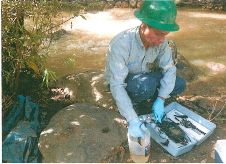
Fotografía N° 7: Medición de parámetros de campo en el punto E- 7
