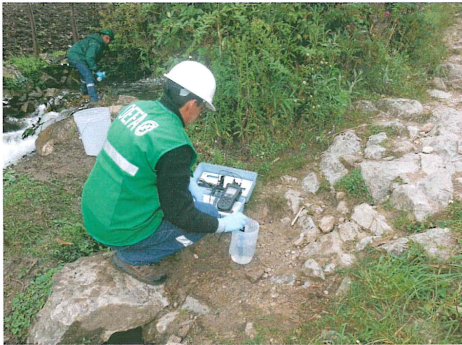
Fotografía N° 9: Medición de parámetros de campo en el punto E- 9
