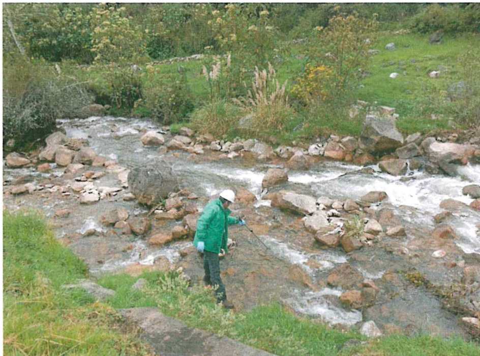
Fotografía N° 8: Medición de caudal en el punto E- 8
