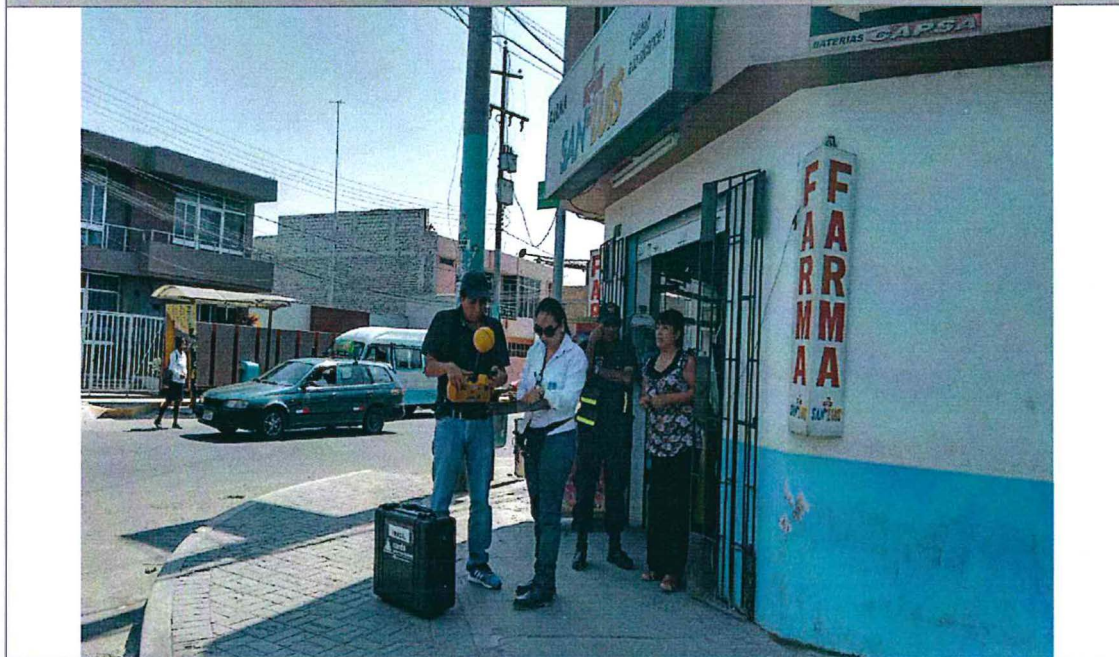
Fotografía N°3: Medición de densidad de potencia con el equipo analizador de campo electromagnético
