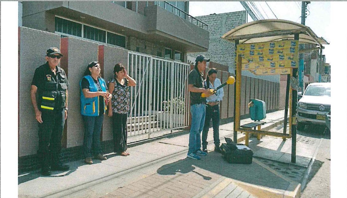
Fotografía N°2: Medición de densidad de potencia con el equipo analizador de campo electromagnético
