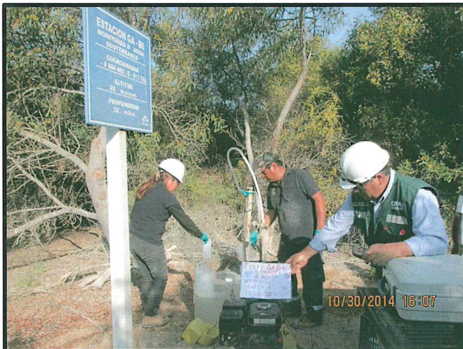
Fotografía N° 11: Toma de muestras de agua subterránea en el punto GA-B6 – acuífero Cascajal
