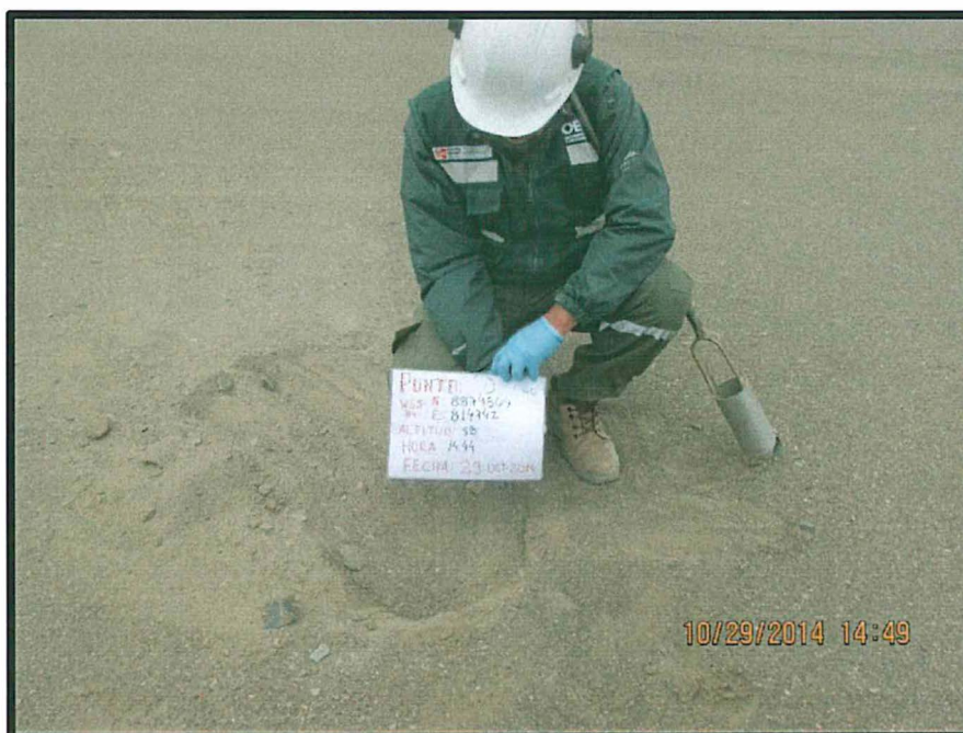
Fotografía N° 29: Toma de muestra de suelo en el punto D - acuífero Cascajal
