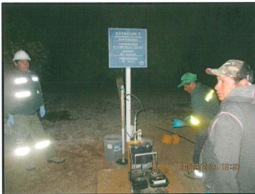
Fotografía N° 23: Toma de muestras de agua subterránea en el punto T – acuífero Huarmey
