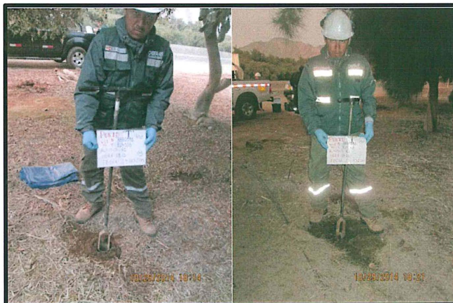
Fotografía N° 27: Toma de muestra de suelo en el punto T - acuífero Cascajal
