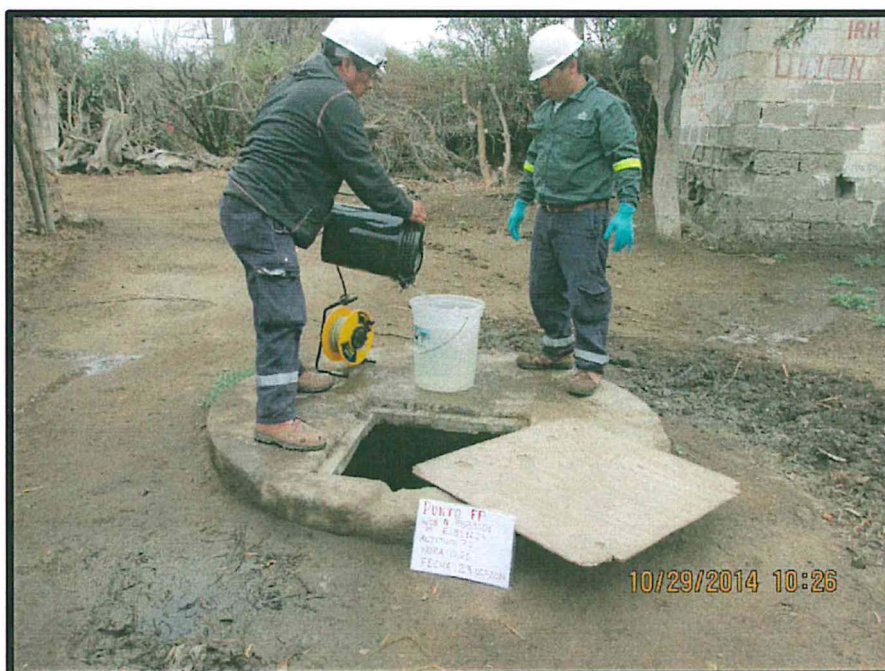
Fotografía N° 08: Toma de muestras de agua subterránea en el punto FP – acuífero Huarmey
