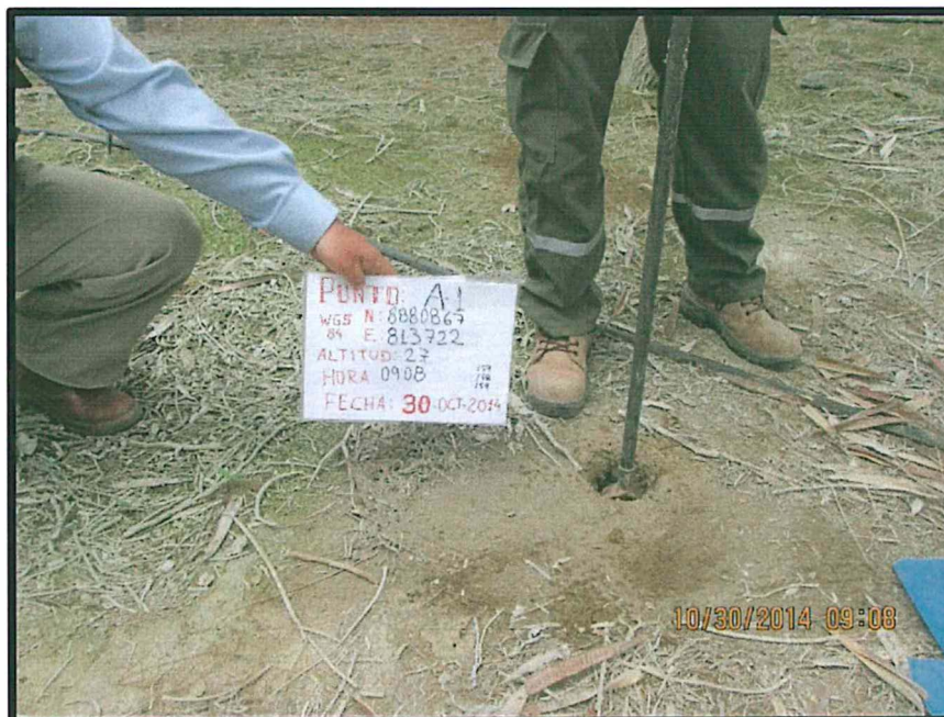
Fotografía N° 25: Toma de muestra de suelo en el punto A-1 - acuífero Cascajal
