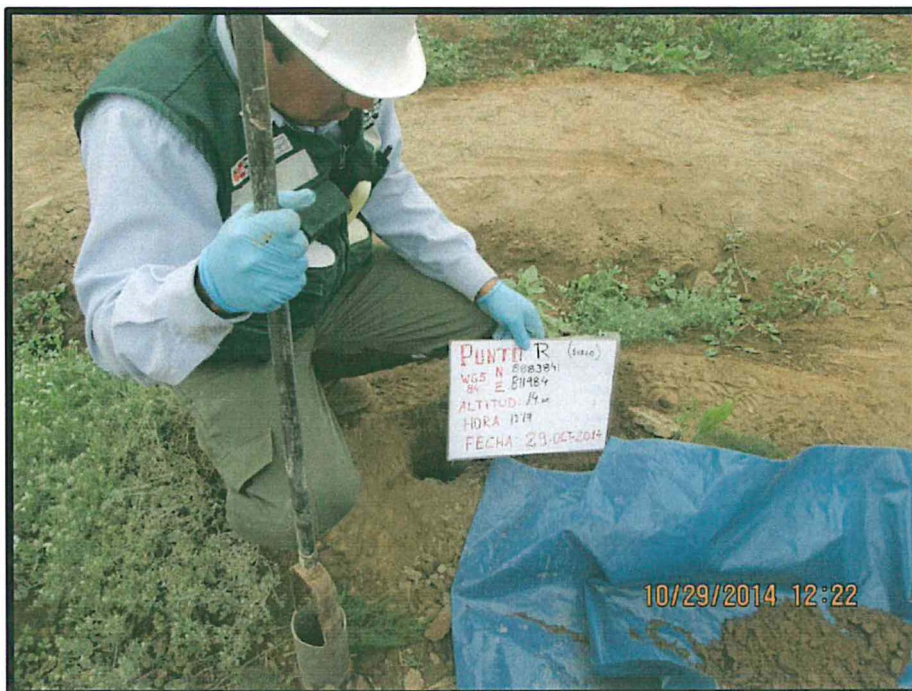
Fotografía N° 30: Toma de muestra de suelo en el punto R - acuífero Huarney
