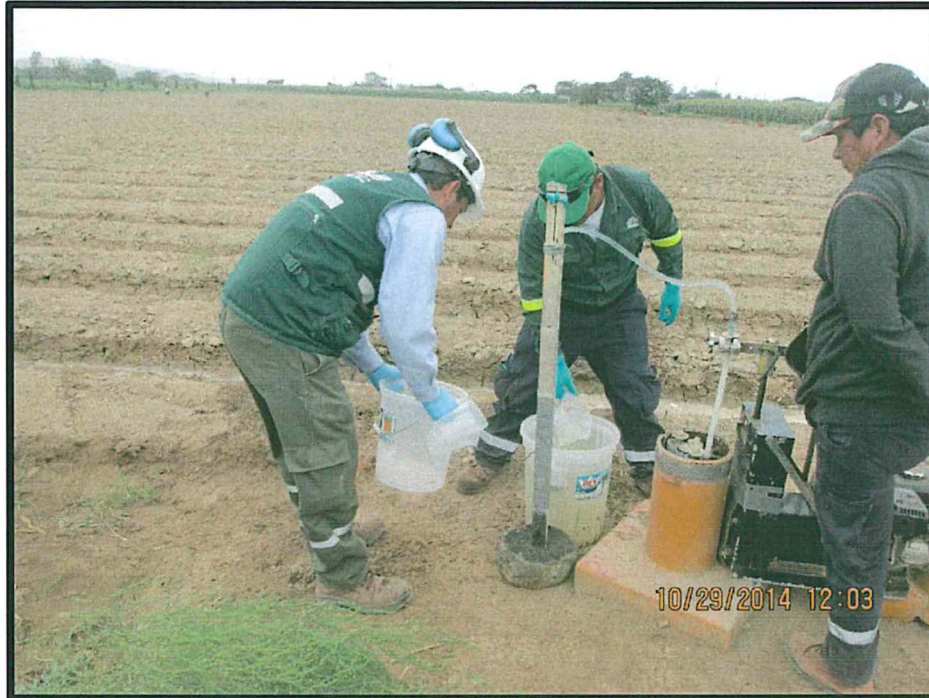
Fotografía N° 12: Toma de muestras de agua subterránea en el punto R – acuífero Huarmey
