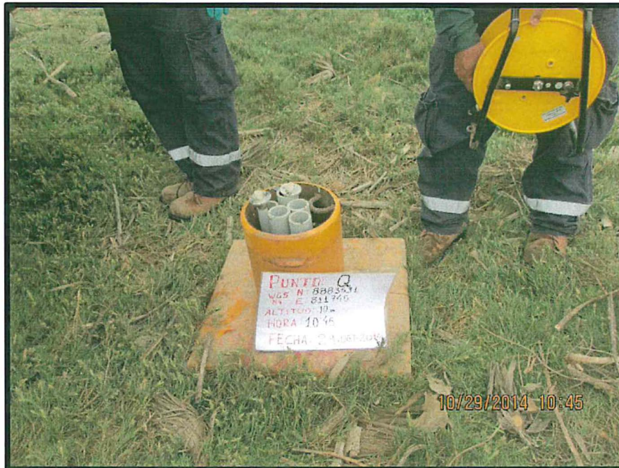
Fotografía N° 10: Toma de muestras de agua subterránea en el punto Q – acuífero Huarmey
