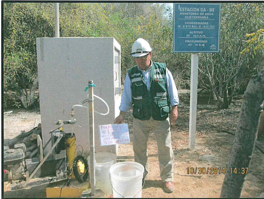
Fotografía N° 16: Toma de muestras de agua subterránea en el punto GA-B9 – acuífero Cascajal
