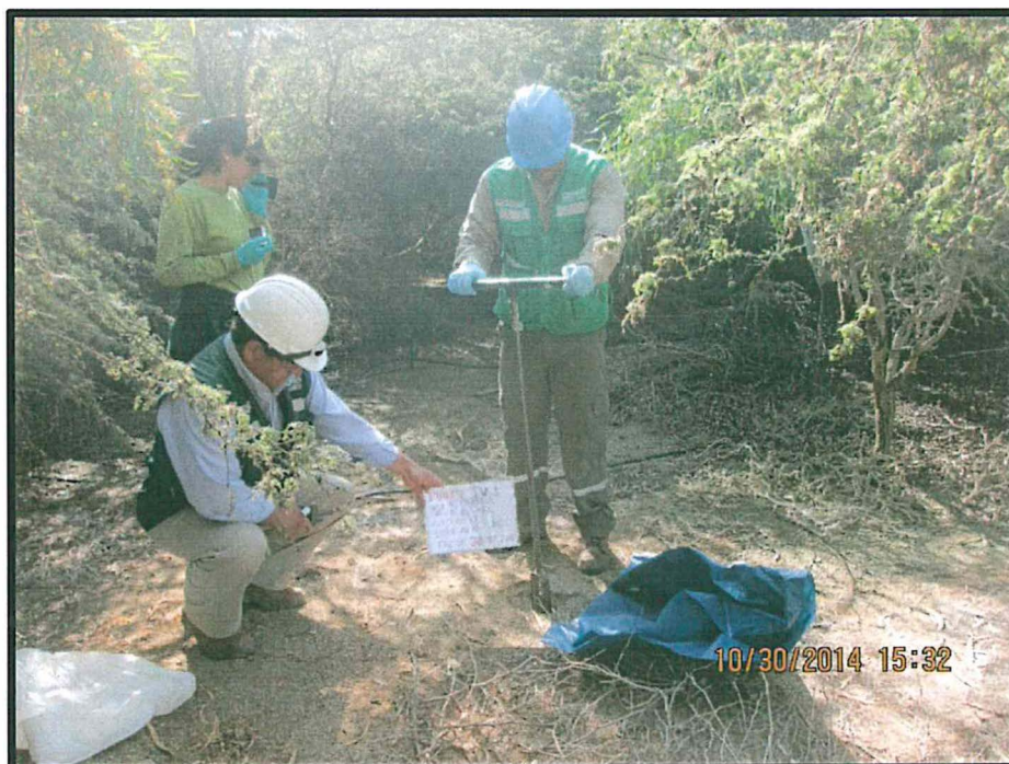
Fotografía N° 15: Toma de muestra de suelo en el punto TW-1 - acuífero Cascajal
