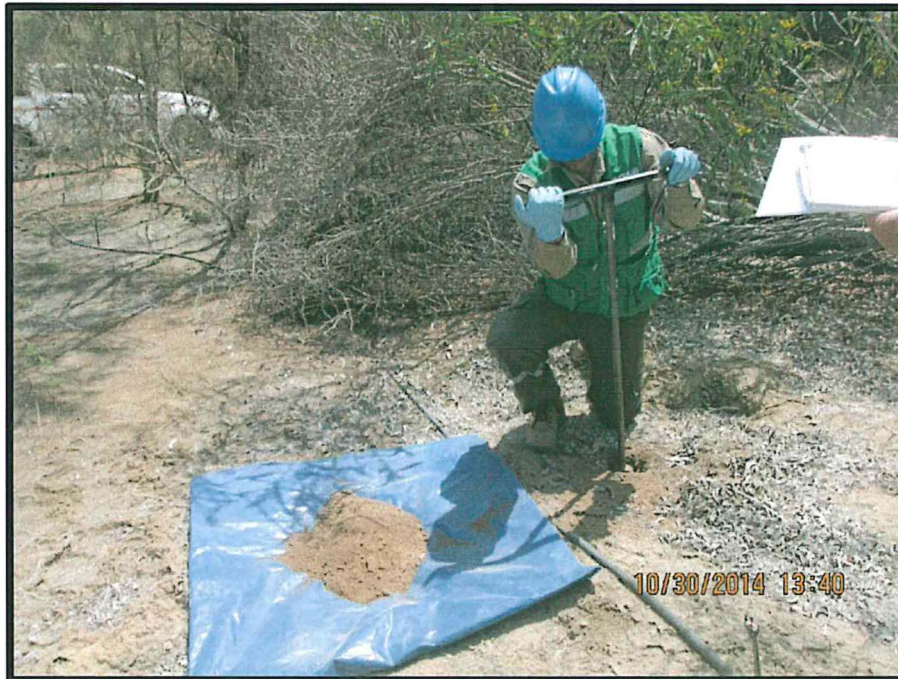
Fotografía N° 18: Toma de muestra de suelo en el punto K - acuífero Cascajal
