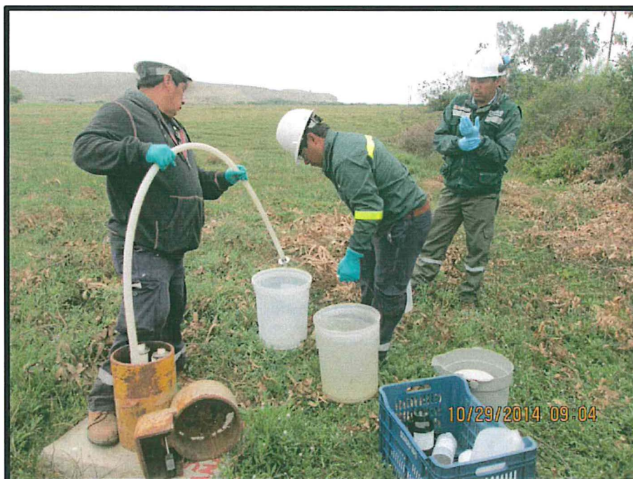
Fotografía N° 06: Toma de muestras de agua subterránea en el punto O – acuífero Huarney
