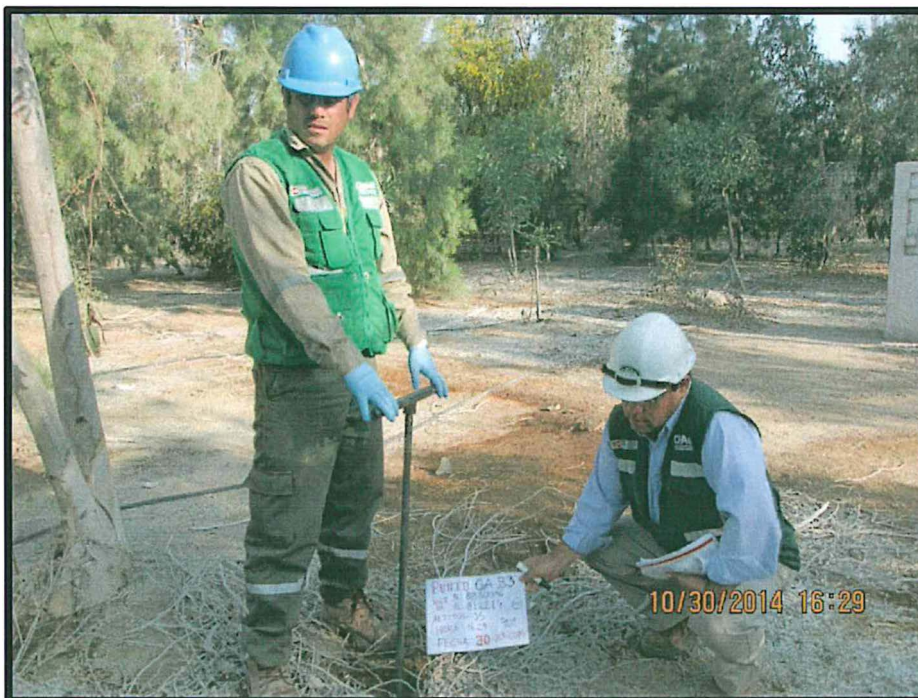
Fotografía N° 15: Toma de muestra de suelo en el punto TW-1 - acuífero Cascajal
