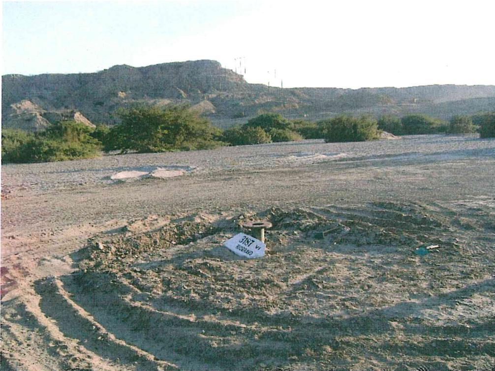
Fotografía N° 1. Pozo mal abandonado, con casing sin tapón y expuesto al aire.
