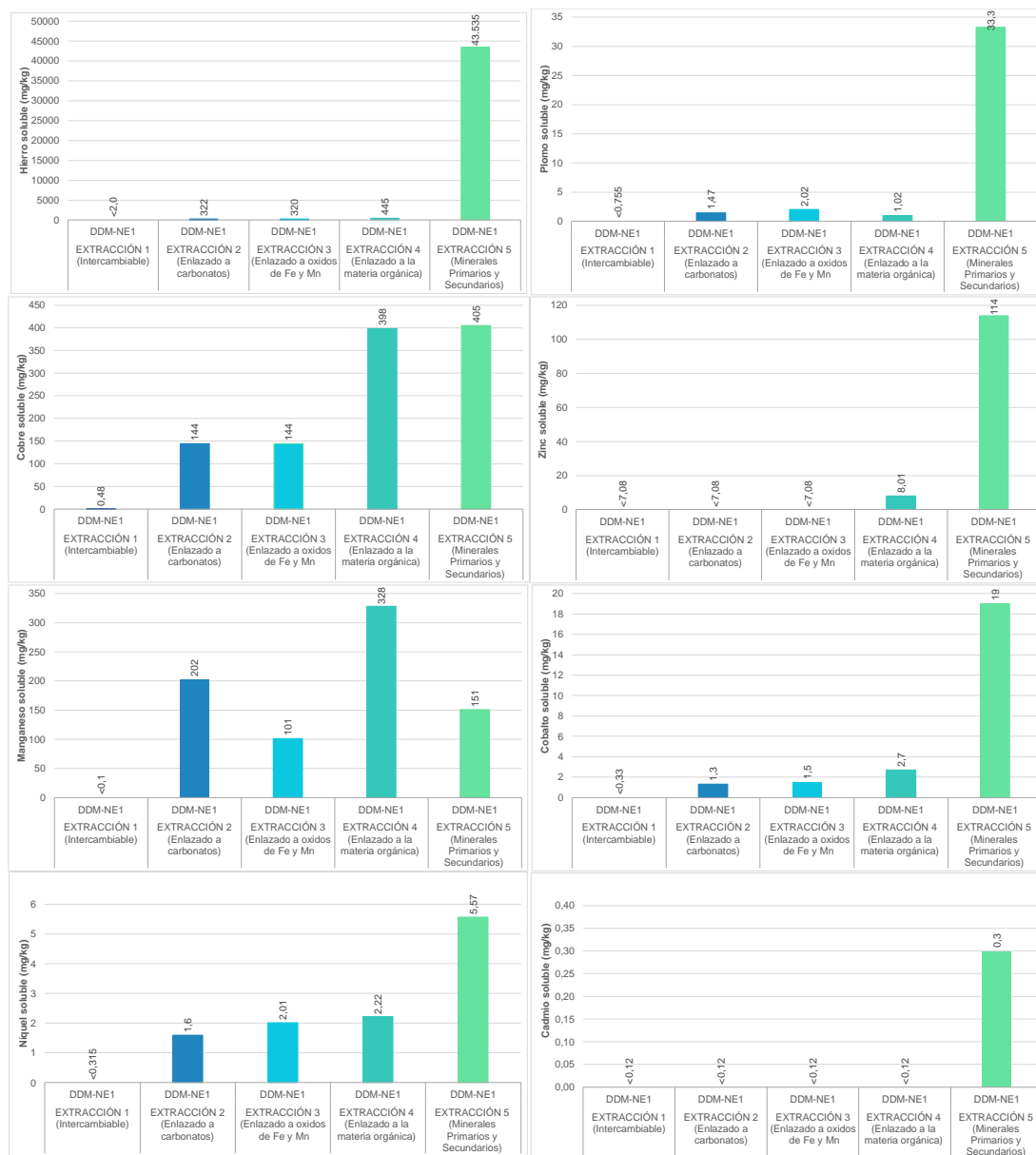
Figura 6-173. Extracción secuencial de metales según la metodología de Tessier en muestras del DDM Noreste - zona III
