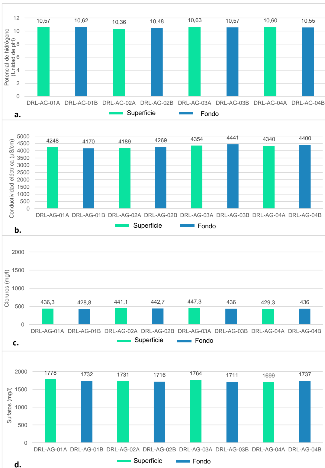
Figura 6-163. Parámetros fisicoquímicos en el depósito de relaves Linga - zona II: a. potencial de hidrógeno, b. conductividad eléctrica c. cloruros y d. sulfatos
