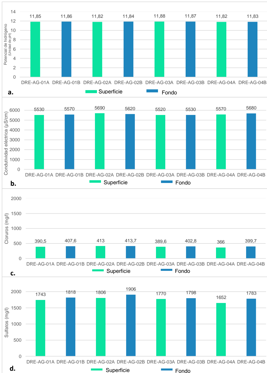
Figura 6-155. Parámetros fisicoquímicos en el depósito de relaves Enlozada: a. potencial de hidrógeno, b. conductividad eléctrica, c. cloruros y d. sulfatos
