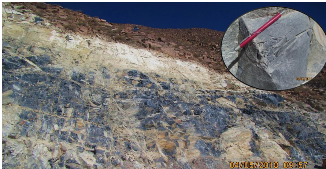
Figura 6-119. Afloramiento de caliza, conformado por estratos gruesos con buzamientos entre 30- 40°
