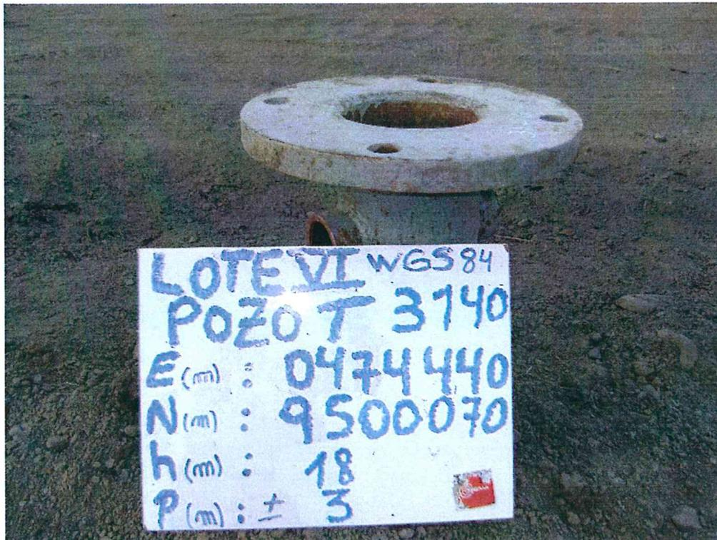
Fotografía N° 1. Se observa pozo inactivo con casing y brida, sin cabezal o válvulas y expuesto al aire libre.
