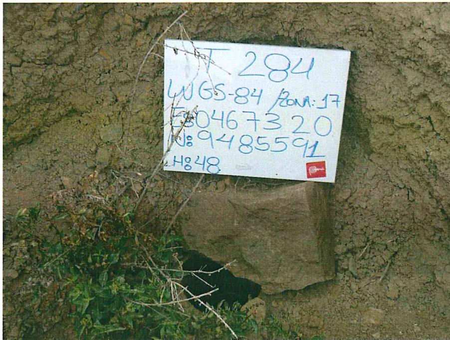
Fotografía N° 1. Pozo inactivo mal abandonado, con código PERUPETRO T\_284, sin cabezal, con casing de revestimiento a nivel del suelo y dentro de un hoyo de 1,35 m de profundidad.
