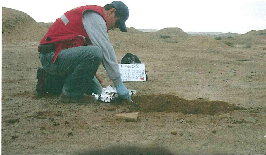
Fotografía N° 3. Recojo de muestra de suelo con posible presencia de hidrocarburo, muestra recogida a 1 m aproximadamente del pozo T4652.
