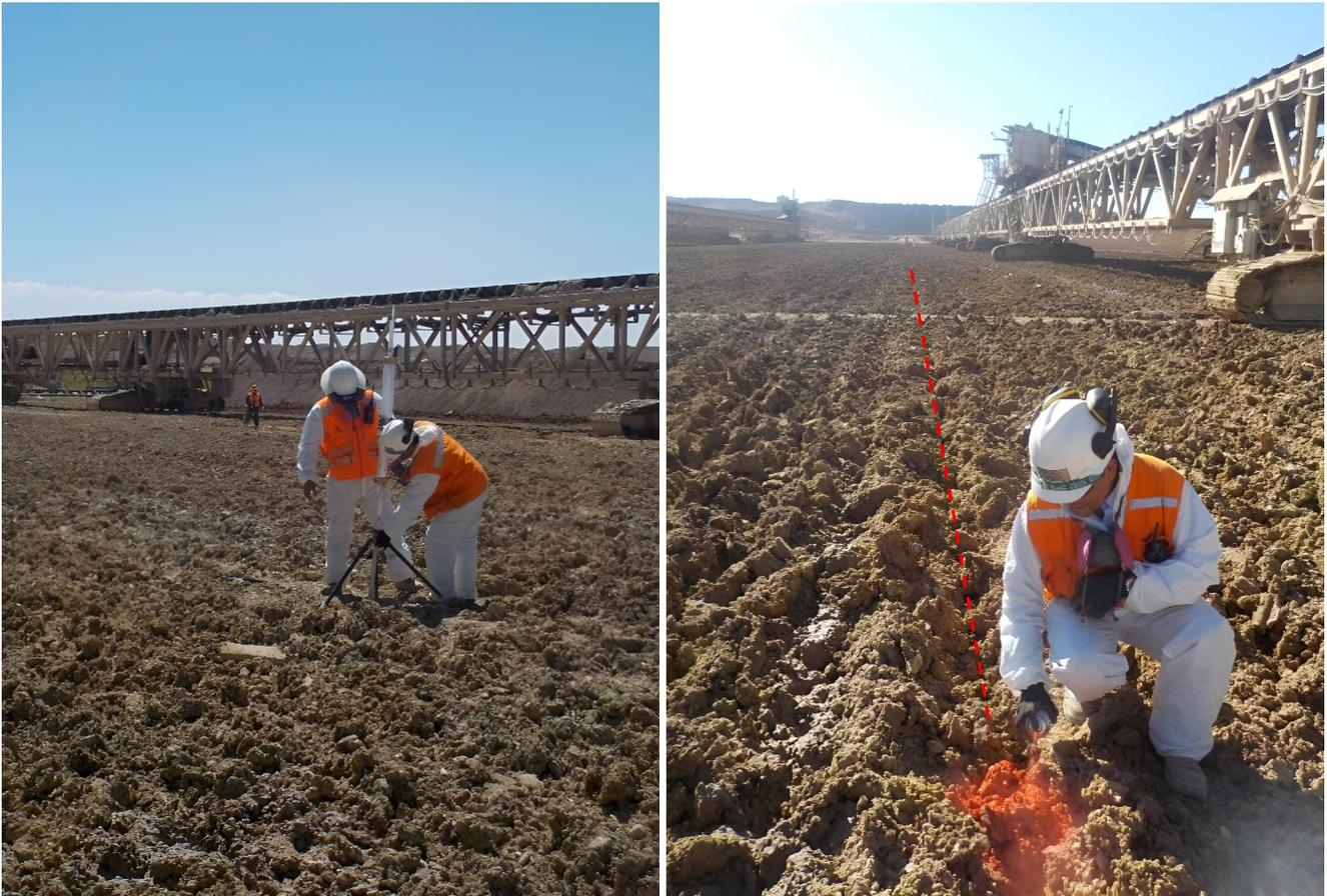
*Nota. Tomado de Schlumberger Water Services Chile (2016). Resultados de los ensayos de permeabilidad in situ sobre pilas de lixiviación, Minera Centinela. Schlumberger Water Services Chile.*
