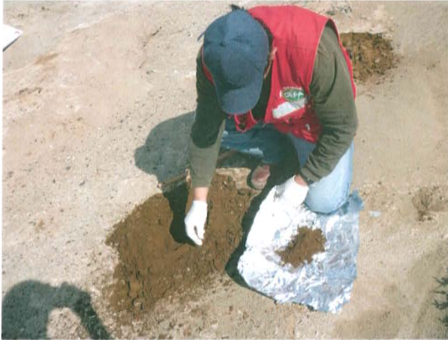
Fotografía N° 3. Toma de muestra de suelo en un área con evidencia de residuos de hidrocarburo.
