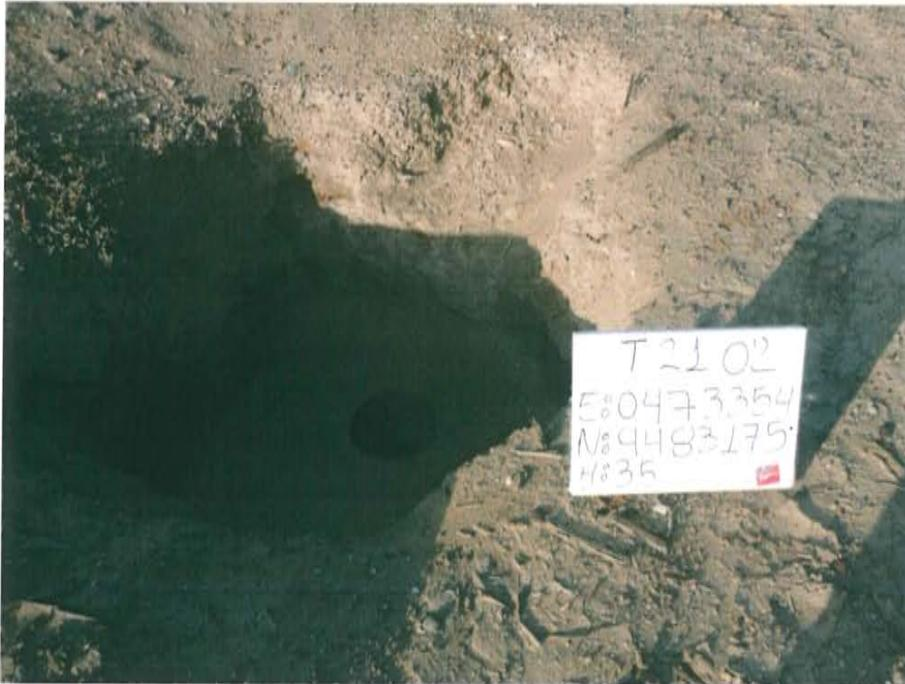
Fotografía N° 1. Pozo inactivo mal abandonado, sin cabezal, dentro de un hoyo de 1,31 m de profundidad, no se percibe emisiones de gases.
