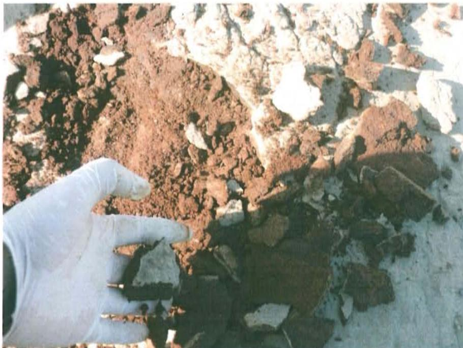
Fotografía N° 3. Se observa suelo impregnado con hidrocarburo.
