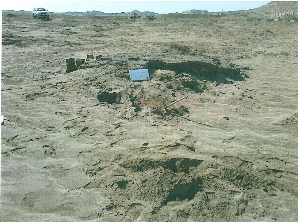
Fotografía N° 4. Se observa que en los alrededores al pozo T\_296, la presencia de suelo impregnado con hidrocarburos.
