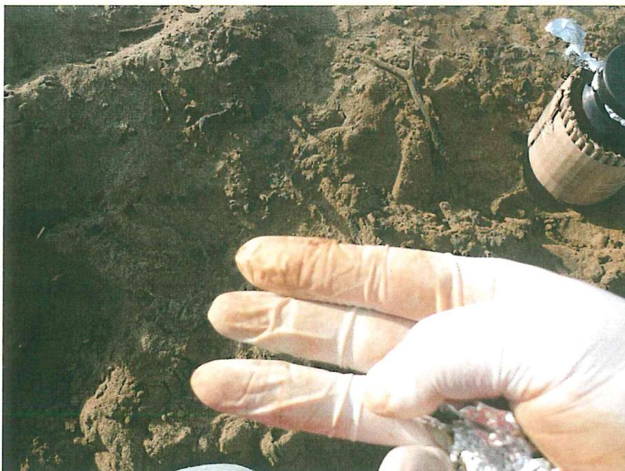
Fotografía N° 3. Se observa la presencia de residuos de hidrocarburo impregnados en el suelo, se recogió muestras para su análisis.
