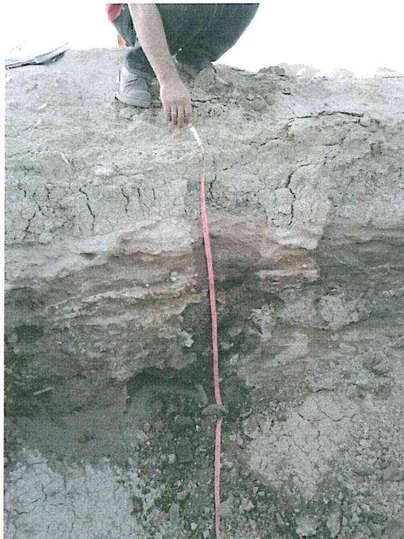
Fotografía N° 4. Se observa a través de la excavación realizada, que el suelo impregnado con hidrocarburos presenta más de 1 m de profundidad.
