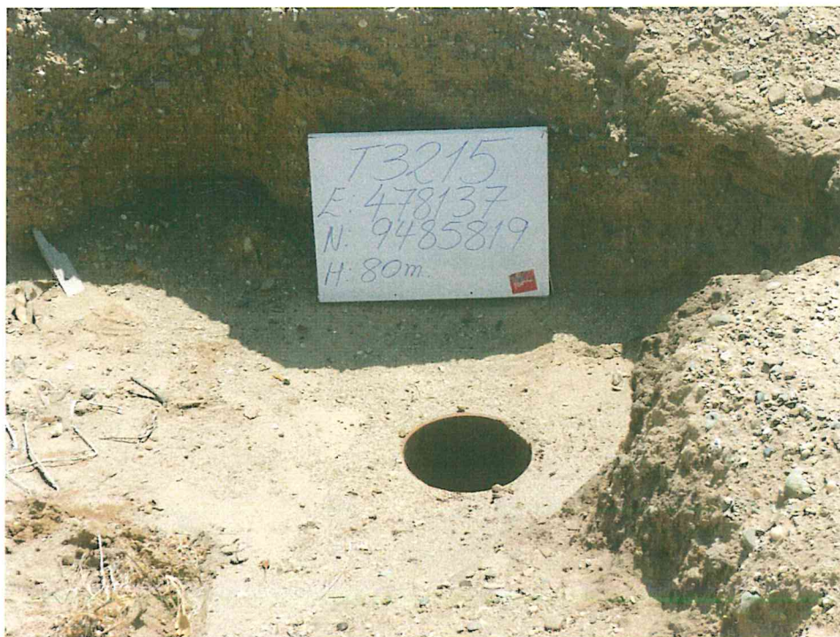
Fotografía N° 1. Presencia del casing (tubería de revestimiento) abierto a nivel suelo, no se percibe organolépticamente olor característico a hidrocarburo.
