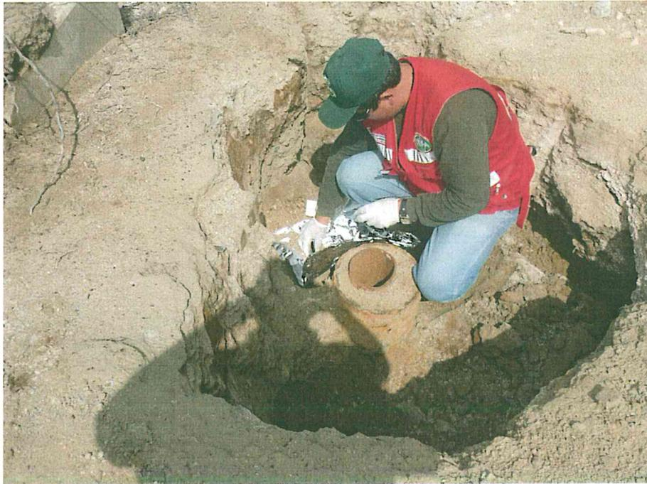
Fotografía N° 3. Toma de muestra de suelo con presencia de residuos de hidrocarburo.
