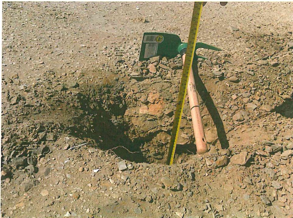
Fotografía N° 4. El suelo con hidrocarburo impregnado presenta olor a hidrocarburos y cambio de coloración.
