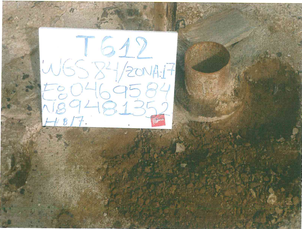
Fotografía N° 1. Pozo inactivo, se observa casing (tubería de revestimiento) y casing de producción.
