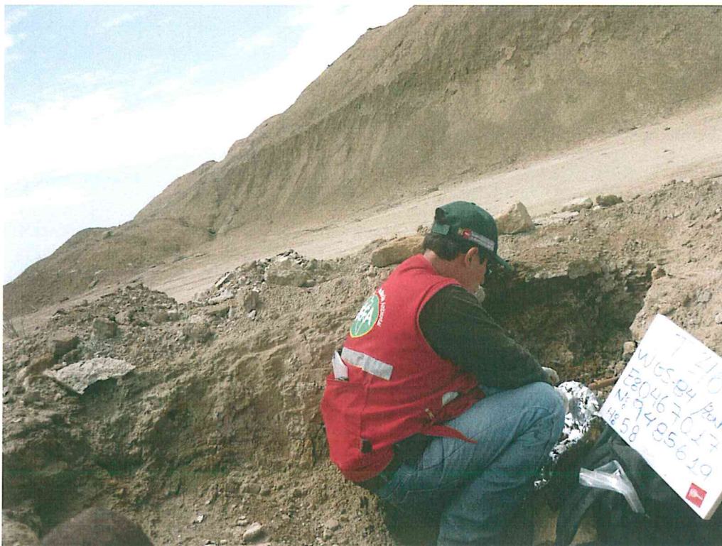
Fotografía N° 3. Toma de muestra de suelo en el área adyacente al pozo evaluado.
