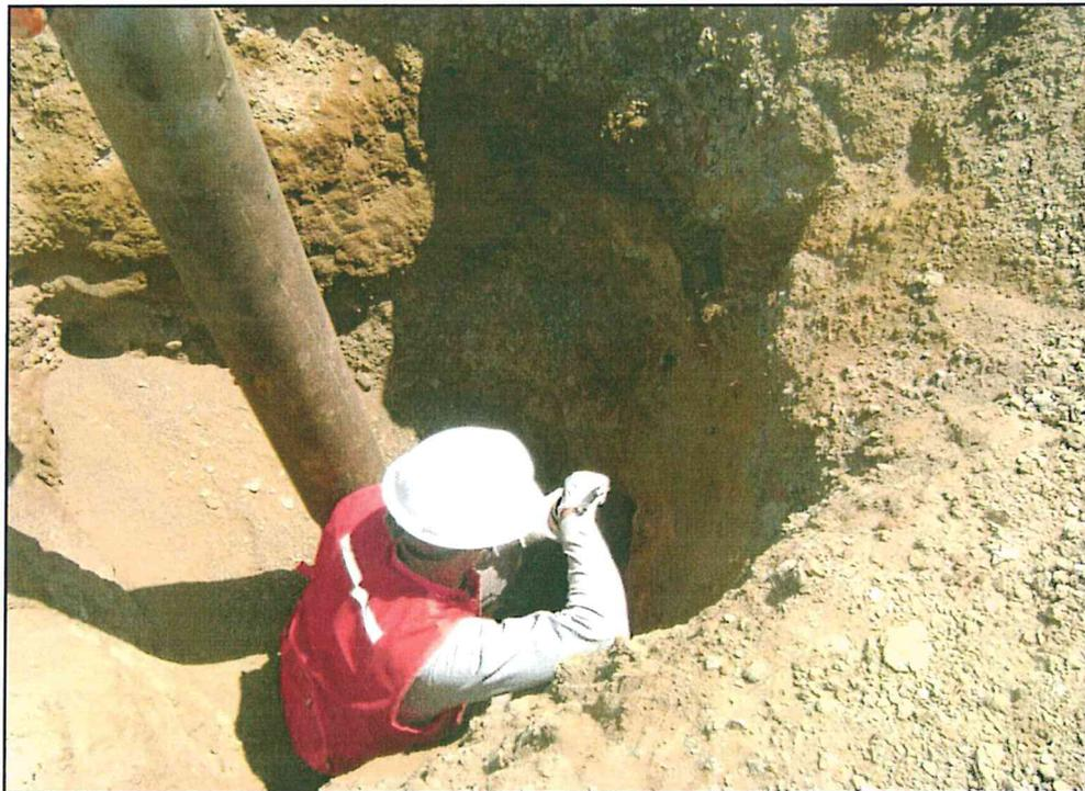
Fotografía N° 2. Se evidencia un forado y suelo impregnado con hidrocarburos, se realizó toma de muestra de forma puntual adyacente al pozo.
