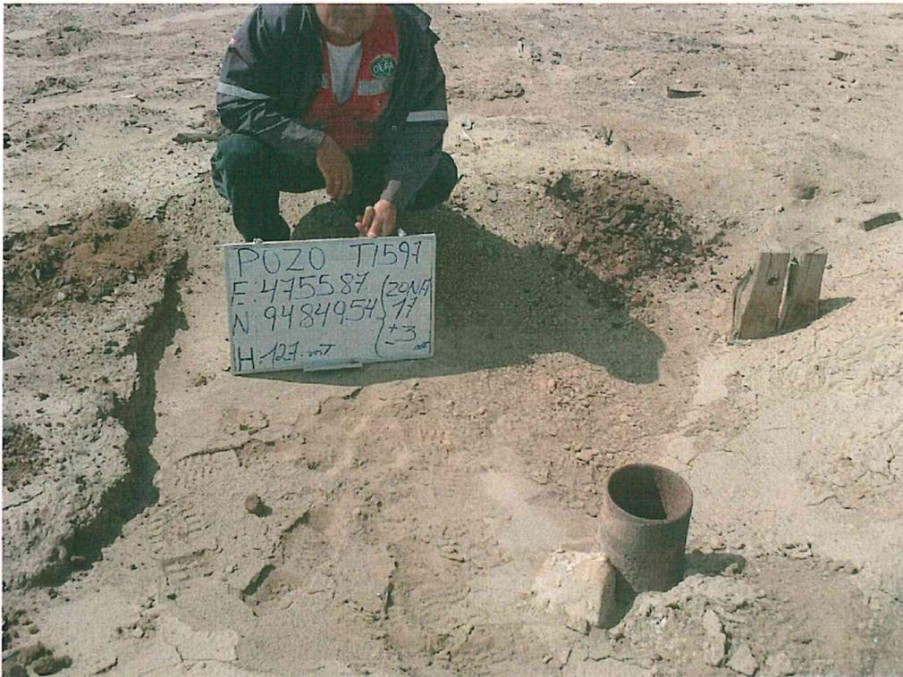
Fotografía N° 1. Vista del pozo inactivo T1597, considerado en estado de abandono ATA, no cuenta con cabezal ni válvulas por lo que se considera abierto.
