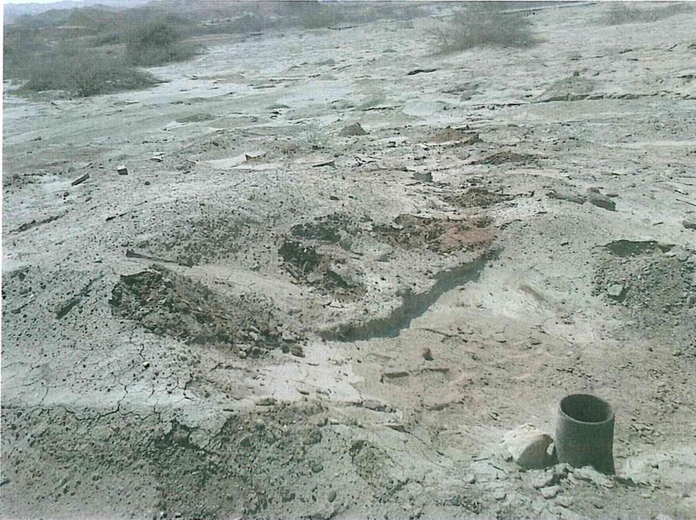
Fotografía N° 3. Vista de suelo impregnado con hidrocarburos en los alrededores al pozo.
