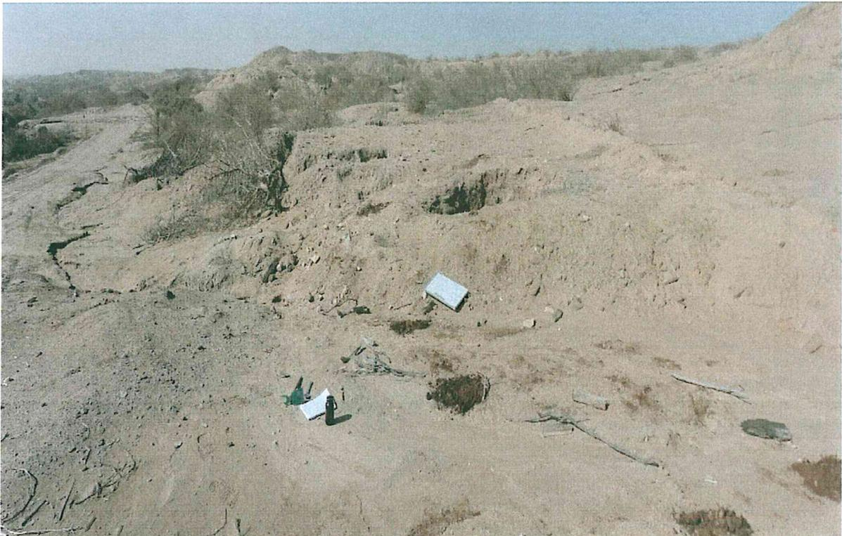
Fotografía N° 4. Vista de alrededores al pozo, se observó en color oscuro los puntos de sondeo donde se observa presencia de suelo impregnado con hidrocarburo.
