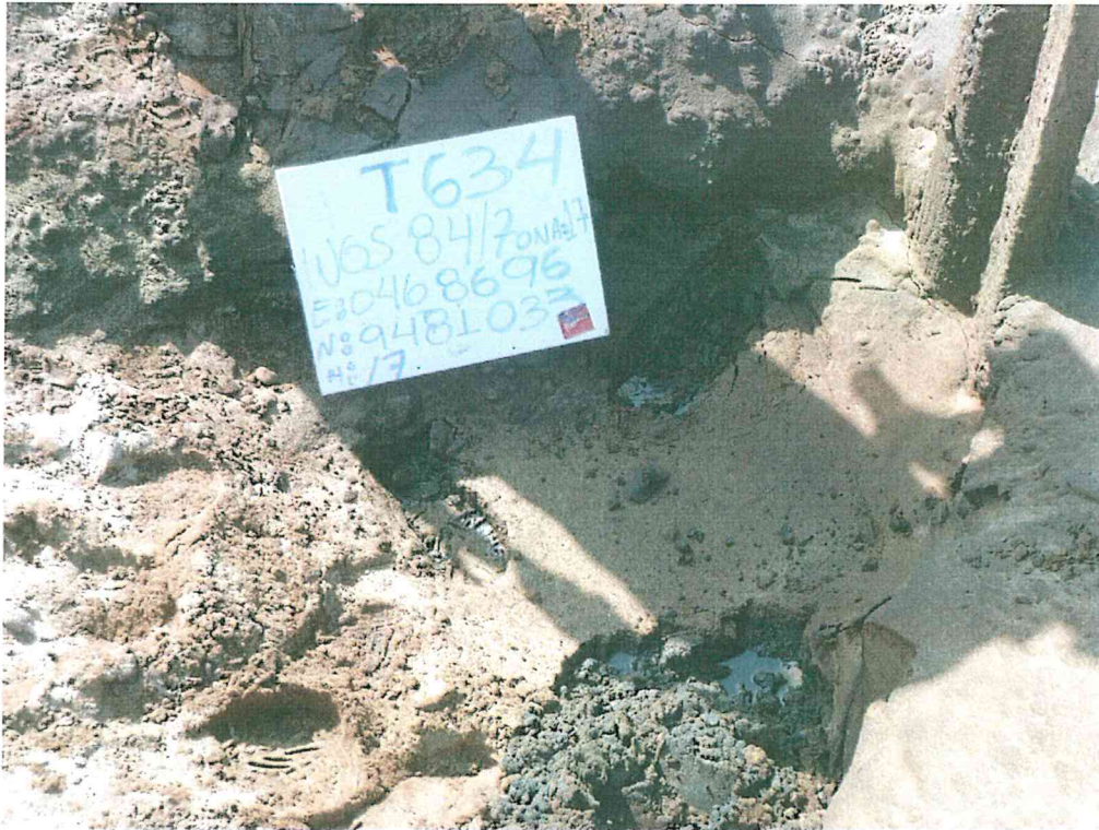
Fotografía N° 1. Pozo con código PERUPETRO T_634 no ubicado a nivel superficial, se observa el afloramiento superficial de hidrocarburo.
