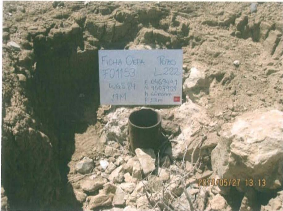
Fotografía N° 1. Pozo L\_222, presenta casing abierto dentro de lo que sería una cantina deteriorada.
