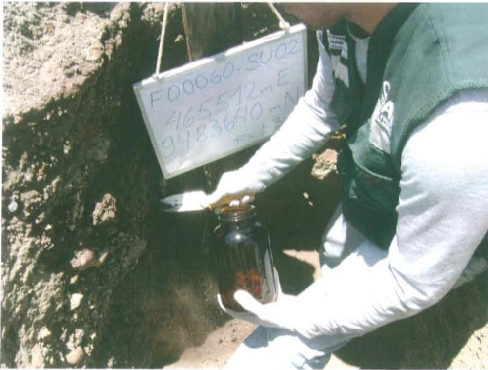
Fotografía N° 3. Toma de muestra a una distancia de 0.5 m del Pozo T_434.
