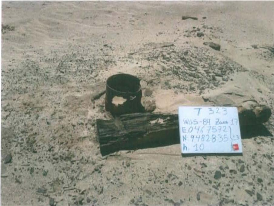
Fotografía N° 1. Se observa casing corroído de 11 pulgadas de diámetro que sobresale 0,23 m de la superficie del suelo.
