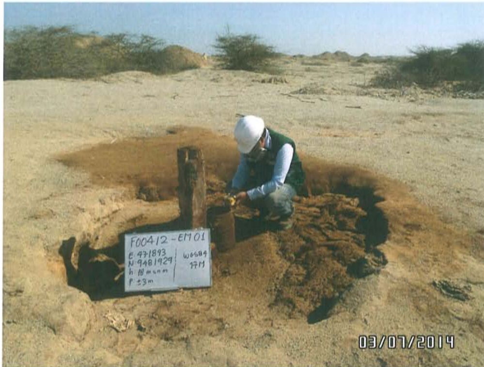
Fotografía N° 3. Medición en el punto F00412-EM01, ubicado en la fuente de emisión en boca del Pozo T1194.
