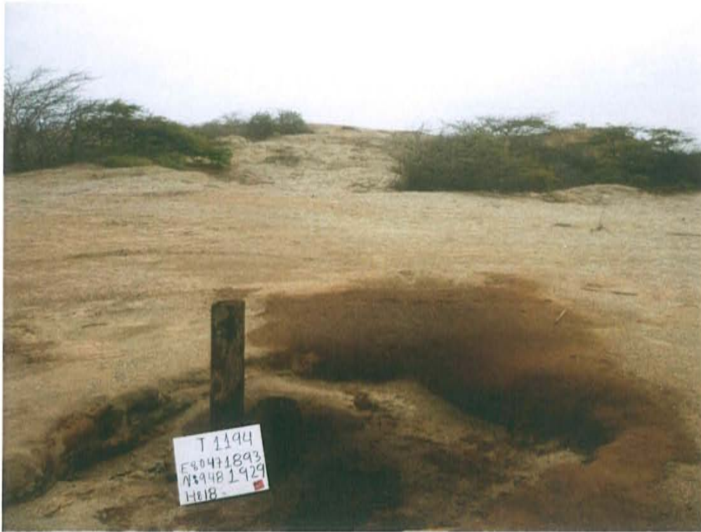
Fotografía N° 1. Suelo impregnado con hidrocarburo en los alrededores del pozo con código PERUPETRO T1194.
