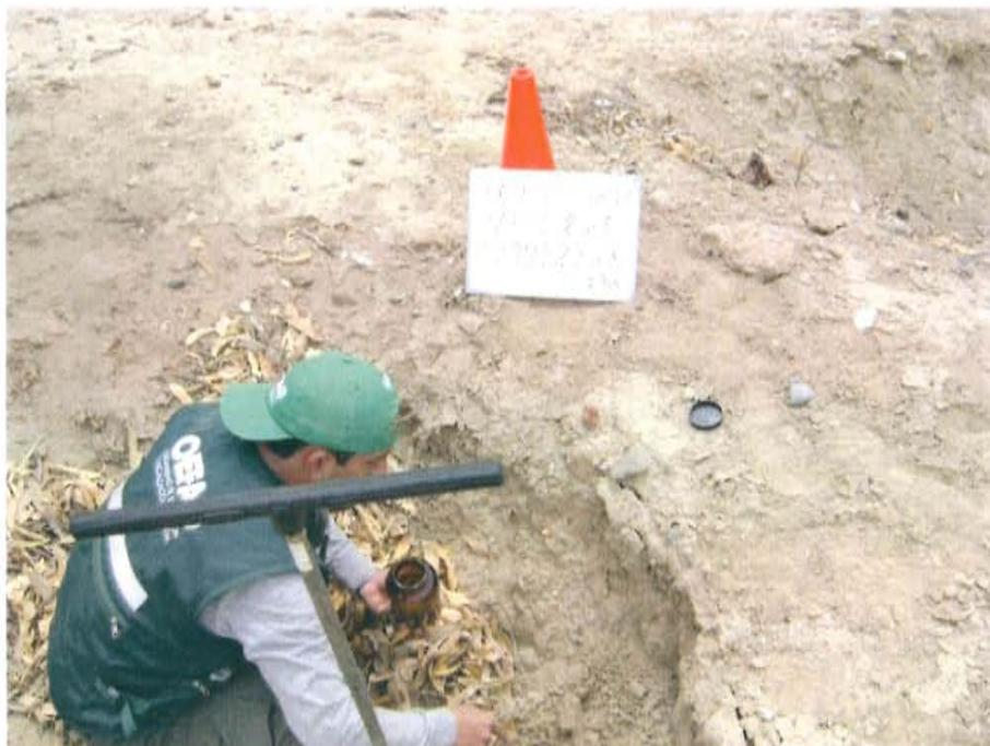
Fotografía N° 4. Toma de muestra de suelo en el punto F00241-SU02, ubicado a 1,50 m aproximadamente del Pozo T3372.
