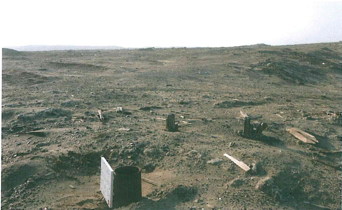
Fotografía N° 2. Se observa casing de aproximadamente 9 pulgadas de diámetro que sobresale 0,34 m sobre la superficie del suelo.
