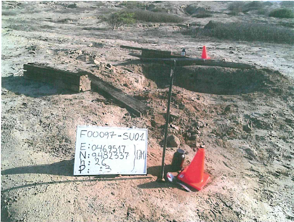
Fotografía N° 3. Punto de muestreo de suelo F00097-SU01, a 3 m al norte del pozo y a una profundidad de 0,30 m a 0,40 m.
